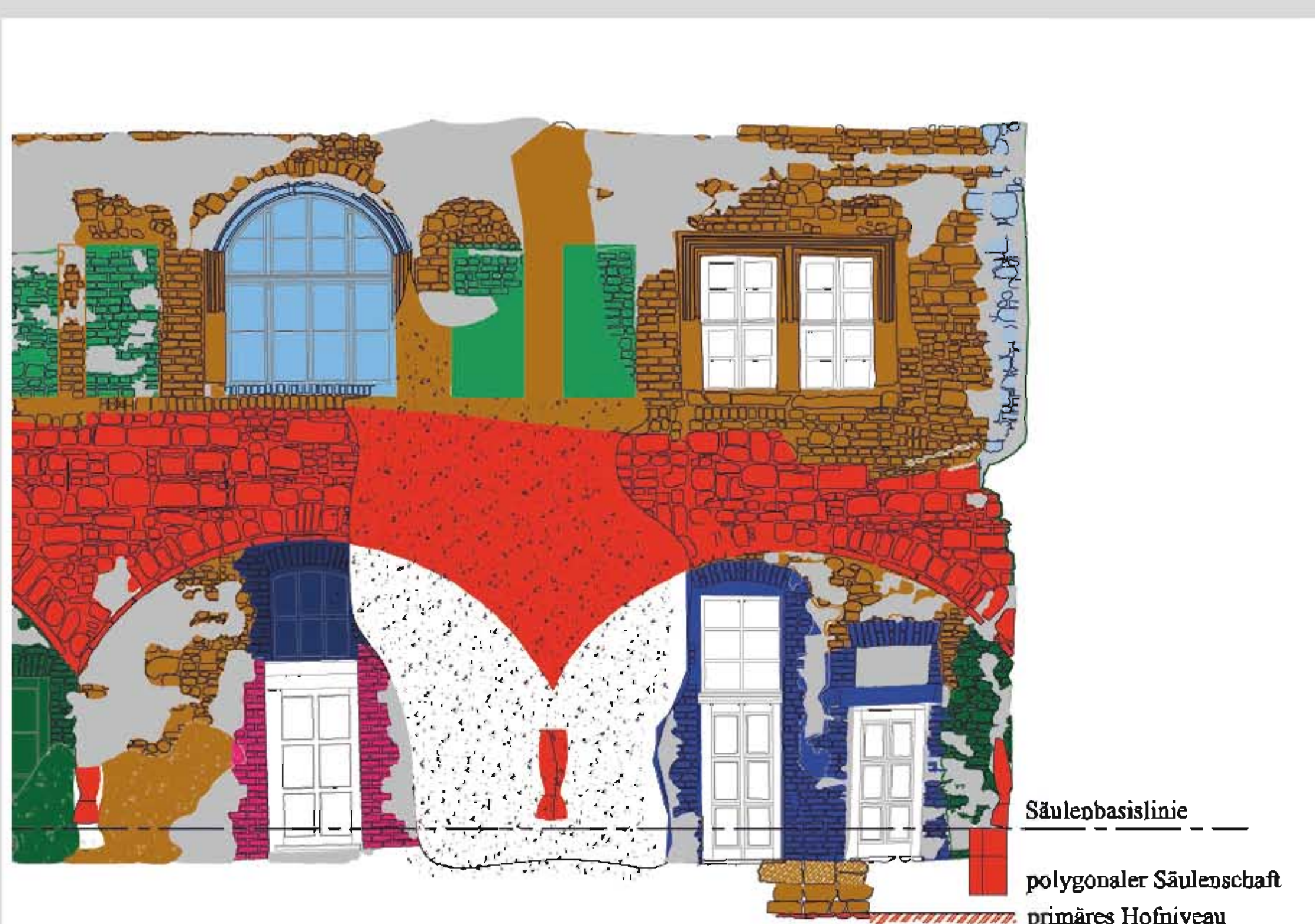
Rekonstruktion der Höhenverhältnisse des ursprünglichen Hofniveaus des 16. Jahrhunderts zu den Säulenbasen der Arkatur im Ostflügel. Baualterskartierung der Hoffassade mit der an das Ende des 16. Jahrhunderts datierten Ausmauerung der Bögen, DuB 2009.
