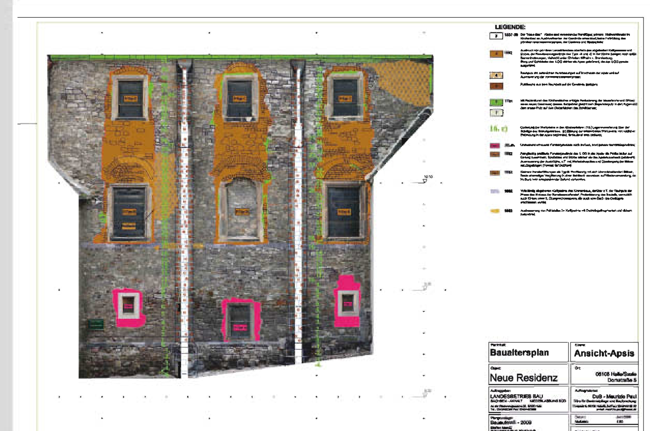
Kartierung von Baunähten und Werksteinlagen in der Fassade der Kapellenapsis in Vorbereitung der Sanierung, DuB 2008, Vermessung S. Marold.
