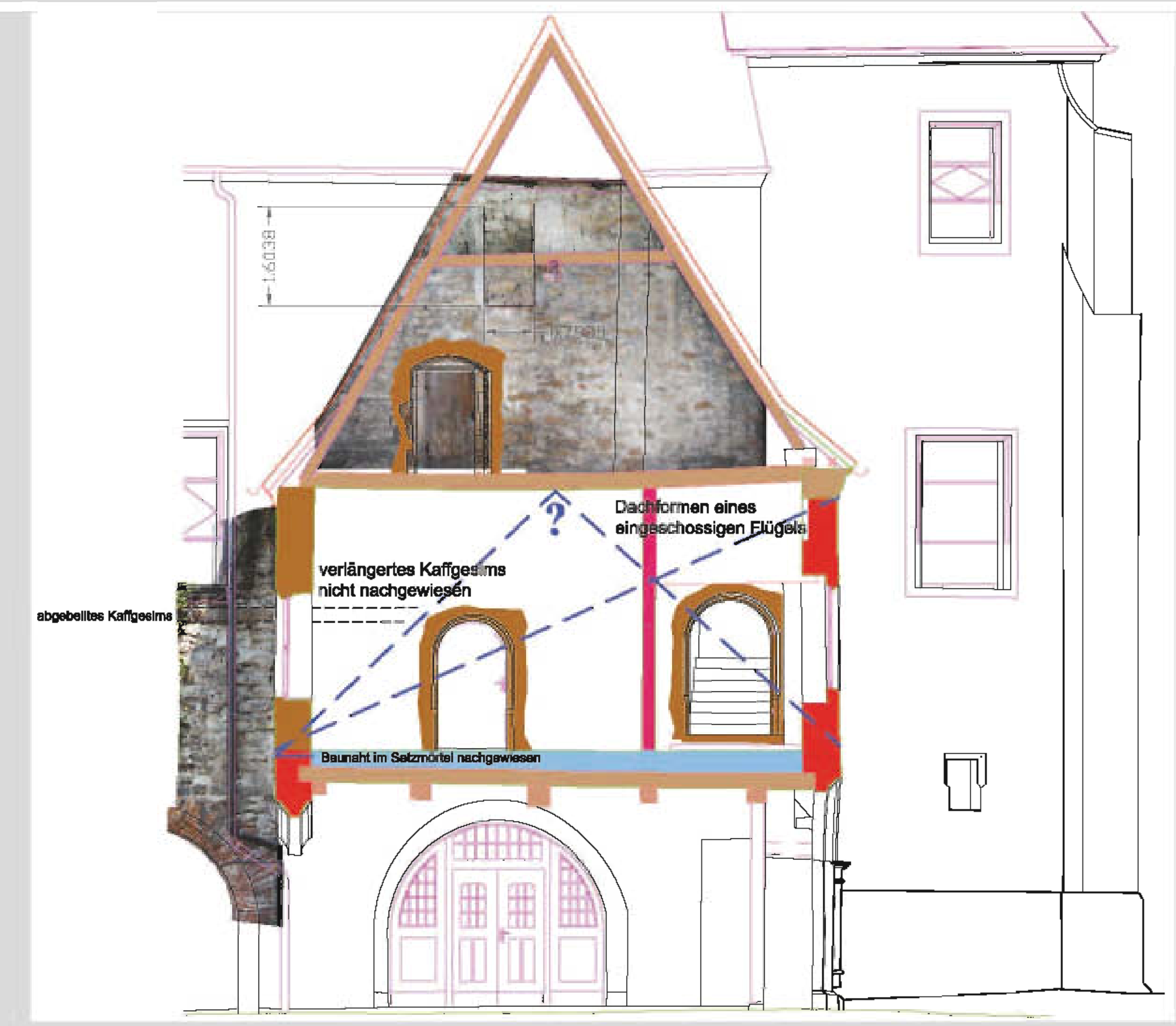
Rekonstruktion eines eingeschossigen Ostflügels mit seinem Anschluss an die Südwand der Kapelle. Die nachträgliche Türöffnung im heutigen Dachraum führte in eine nachträgliche, 2. Obergeschossebene des Kapellensaals, darüber die Öffnung eines originalen Kirchenfensters der Bauzeit von 1539, DuB 2009, Vermessung S. Marold 2004.
