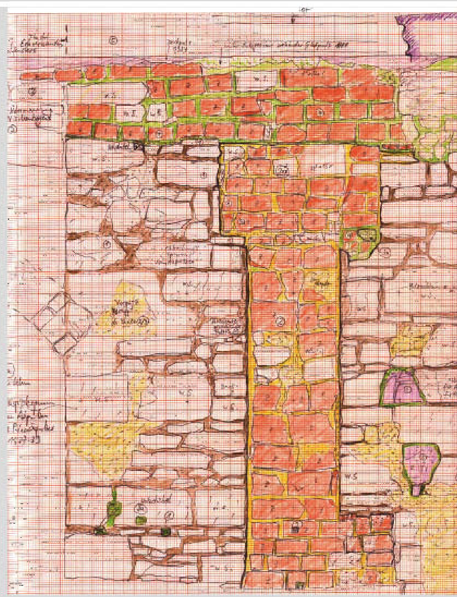
Zeichnerische Dokumentation eines ausgebrochenen Gewölbedienstes mit der ehemals abschließenden, breiteren Konsole, DuB 2010.
